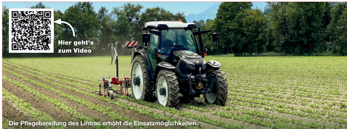
**Die Pflegebereifung des Lintrac erhöht die Einsatzmöglichkeiten.**
